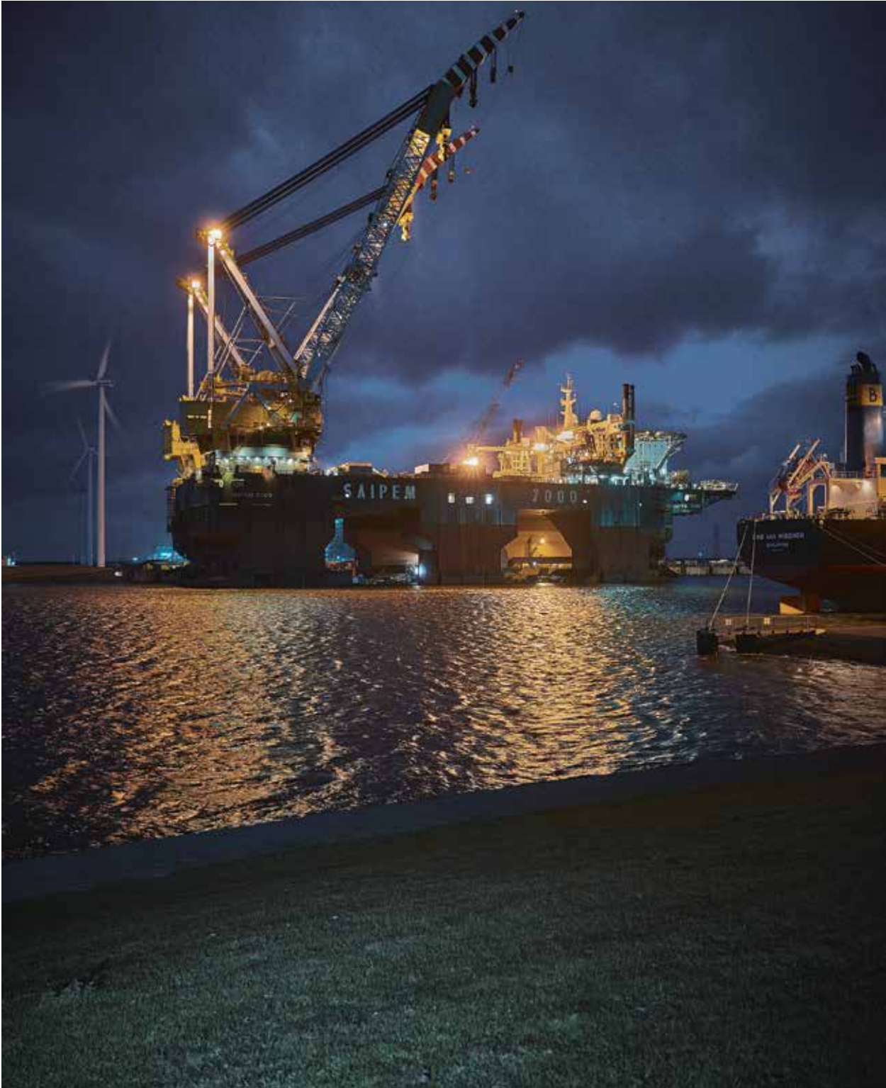
Tiefwasser-Errichterplattform „Saipem 7000“, Eemshaven, Niederlande
